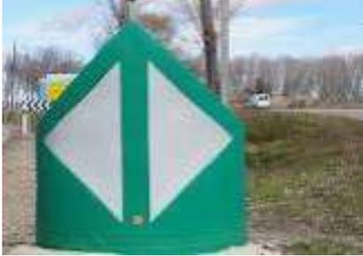
Este elemento de forma semicilíndrica con dos triángulos opuestos indica el punto en el que se separan dos carriles que toman una dirección distinta.
